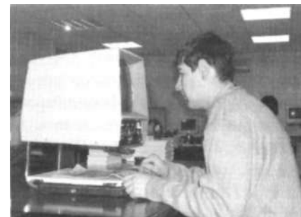
Телевизионное увеличивающее устройство позволяет слабовидящим читать печатные тексты
